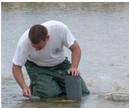
Figura 1.4. Muestreo con surber en ambientes fluviales: a) detalle; b) contra corriente, recogiendo material de deriva.
