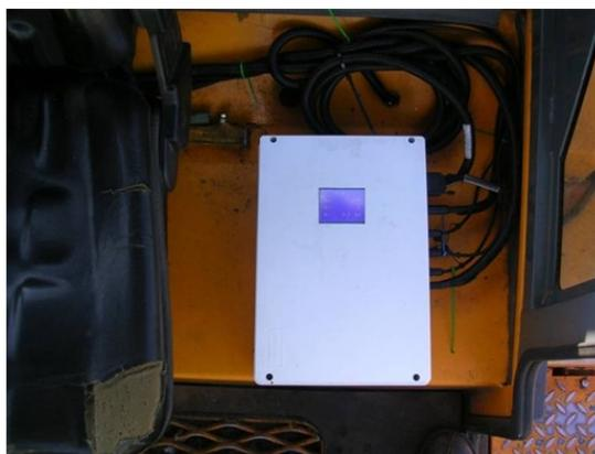
Figura 4. Unidad de Control instalada en la cabina de la segunda cosechadora de aceitunas.
