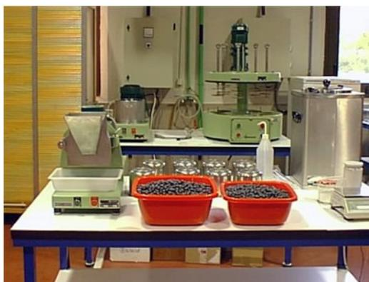
Figura 1: Equipamiento utilizado en el método de abencor de extracción de aceite de olivas. Foto por: [http://www.uclm.es/grupo/gao/lab/lab-qui\\_gao.htm](http://www.uclm.es/grupo/gao/lab/lab-qui_gao.htm)
