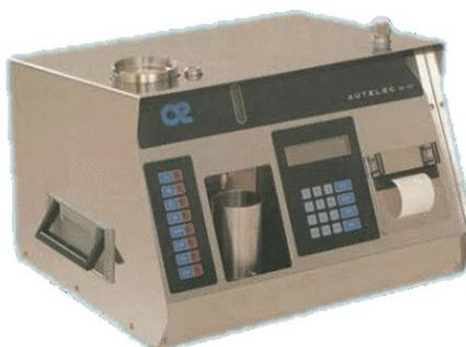
Figura 3: Equipamiento de extracción Autelec.
