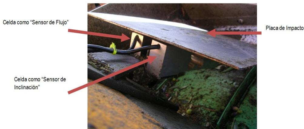
Figura 3. Ubicación Celda de Carga como “Sensor de Inclinación”.
