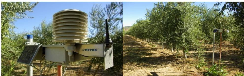
Figura 2. Estaciones meteorológicas automáticas localizadas en terreno con conexión GPRS directa a sistema de base de datos e internet.
