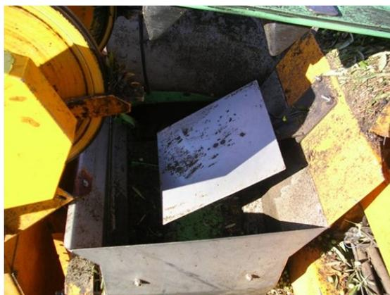
Figura 5. Placa de Impacto con Celda de Carga instalada en la línea de cosecha derecha.
