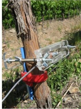
Figura 6: Dendrómetro instalado en la parra frente a la cámara.
