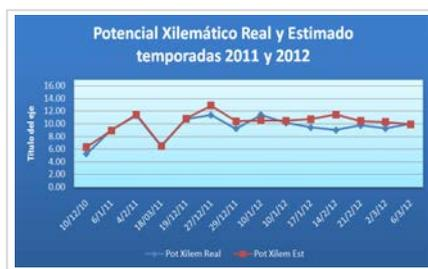
Figura. 25. Evolución de potencial xilemático estimado (termografía) y real (Scholander) para las temporadas 2011 y 2012.
