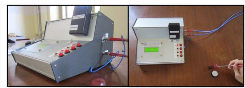
Figura 7. Imágenes de prototipo de equipo VIS/NIR para uso en condiciones de laboratorio para análisis de calidad de fruta desarrollado por el equipo de la Universidad de Milán.
