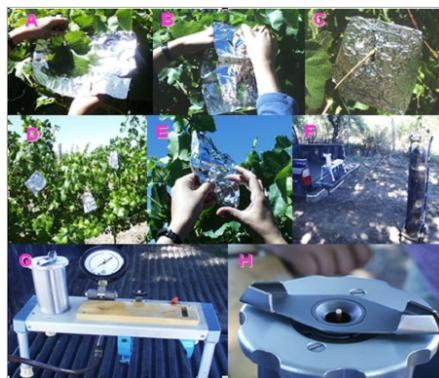
Figura 17. Etapas a seguir en la medición del potencial hídrico en las hojas con la Bomba Scholander. Selección de hojas (A), Cubrimiento de hojas con papel aluza (B, C y D), Hoja lista para ser evaluada (E), Lugar e instrumento de medición (F y G) y Lectura del potencial hídrico de la hoja (H).
