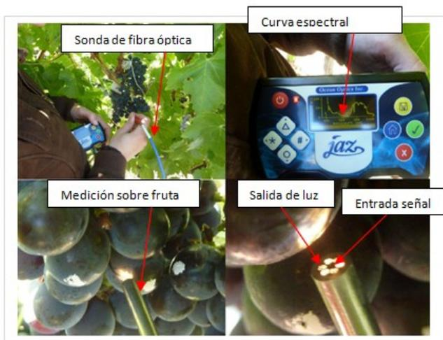
Figura 4. Adquisición de información espectral en bayas frescas con el sistema de Vis/NIR (JAZ) en condiciones de terreno.
