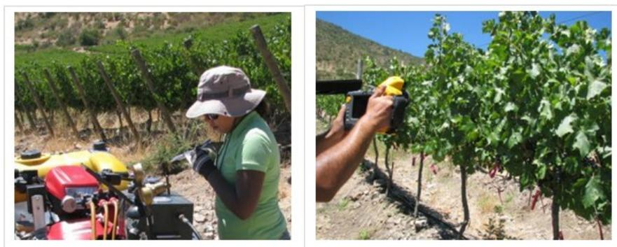
Figura 13. (a) Determinación de potencial hídrico mediante sistema Scholander y (b) captura simultánea de termografía para determinación de índice CWSI.
