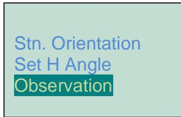
Si enfocó adecuadamente el prisma, el aparato mostrara la coordenada calculada en pocos segundos, hasta este momento, el prisma puede moverse a la siguiente ubicación mientras utilizamos la opción “Rec” (Grabar) en pantalla, para guardar el dato. Se le solicitará confirmar la siguiente información:
