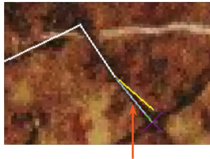
Con Modify Element estire la línea hasta el vértice errado
