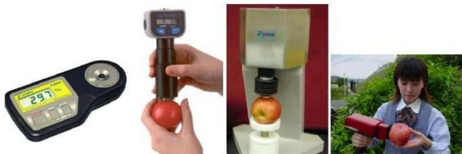
Figura 19. Equipos de medición de características de calidad no destructivos.
