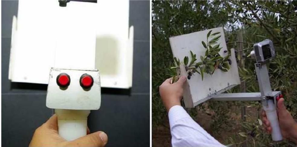
Figura 14: cámara Sony Dsc-s650 modificada para capturas de imagen en terreno con dispositivos de maniobrabilidad y soporte.
