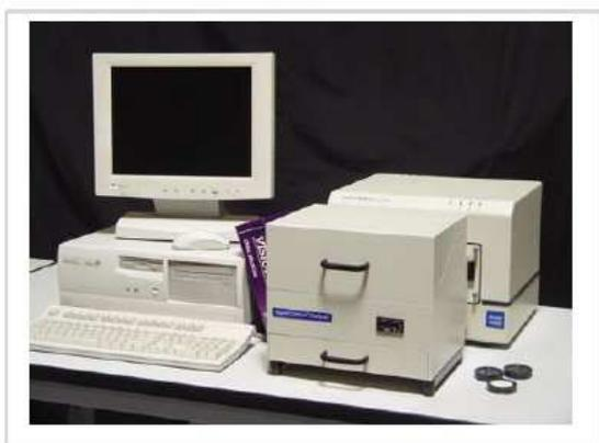
Fig. 3. Ejemplo de un Espectrómetro NIR de laboratorio. (Foss NIRsystems Series-5000).
