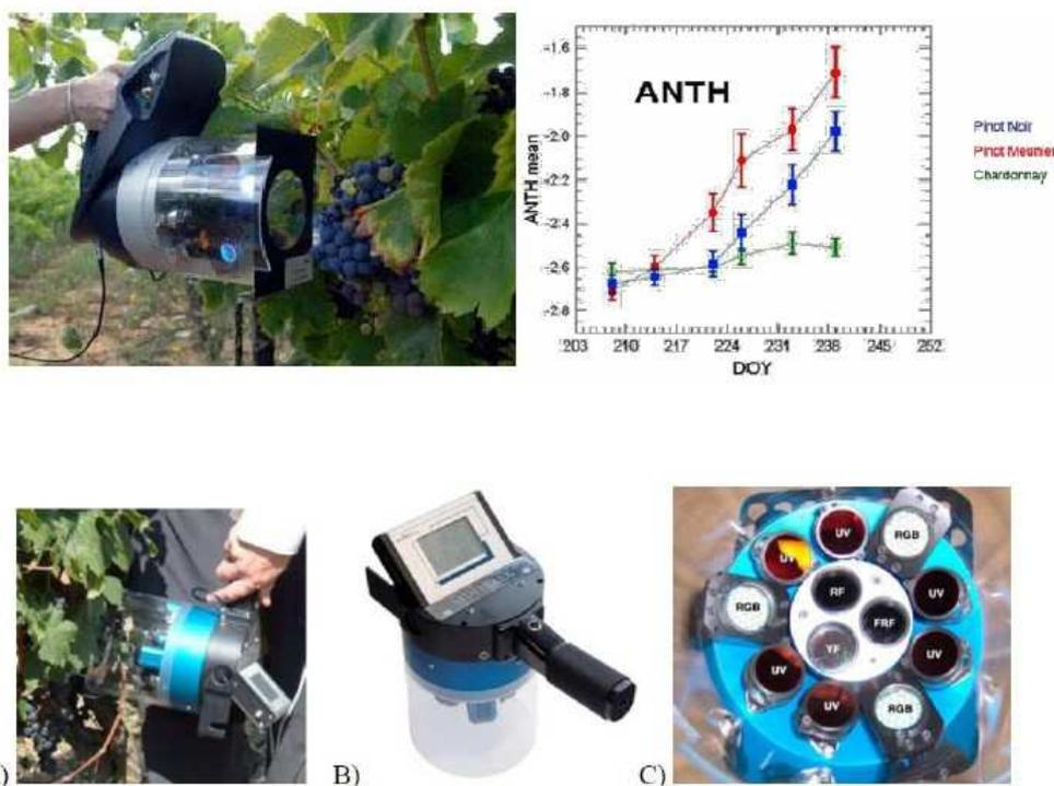
Fig. 20. El sensor de Multiplex. A) Medición en el campo. B) Vista superior del sensor que muestra la interfaz de pantalla táctil y el botón de disparo. C) Vista frontal de la cabeza óptica con fuentes de LED (6 UV y 3 RGB) y tres detectores en el medio (YF, FRF, RF).
