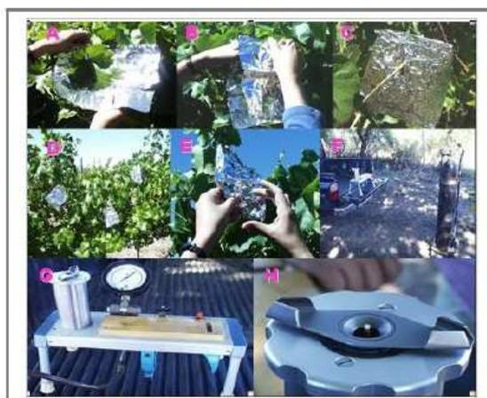
Figura N°15. Etapas a seguir en la medición del potencial hídrico en las hojas con la Bomba Scholander. Selección de hojas (A), Cubrimiento de hojas con papel aluza (B, C y D), Hoja lista para ser evaluada (E), Lugar e instrumento de medición (F y G) y Lectura del potencial hídrico de la hoja (H).
