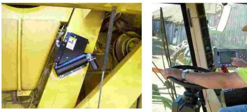
Fig 17 (a,b) monitor de rendimiento instalado en maquinaria
