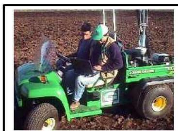
Figura 27. Toma de muestras de suelo, georeferenciadas con GPS Diferencial.
