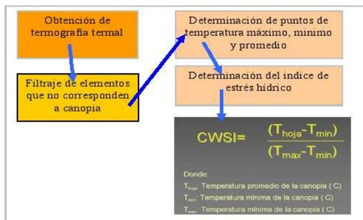
Figura 21. Esquema de los pasos seguidos para la obtención de CWSI, a partir de la termografía termal.
